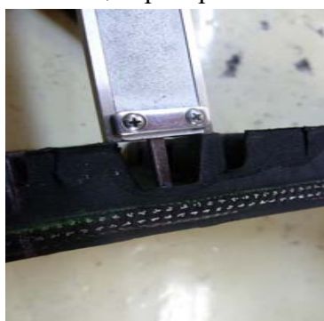
Фото 1 - Измерение высоты рисунка протектора
